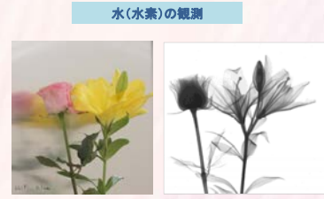
中性子は水(水素)を観測しやすい写真はバラとユリ内部の水の分布(ラジオグラフィ)
